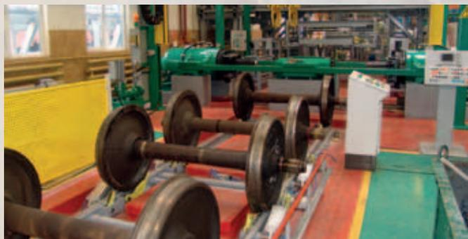
**Автоматизированная линия для ремонта колесных пар**
