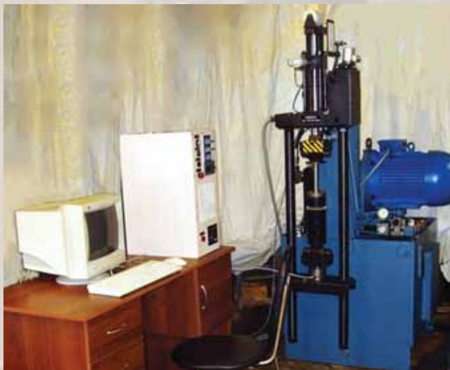
Рис. 1. Компьютеризированный стенд СА-5 для испытаний гидравлических демпферов.
