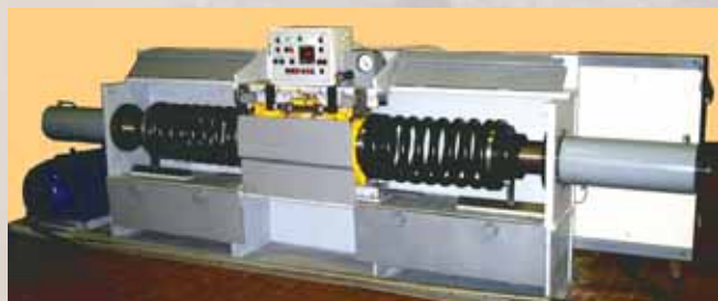
Рис. 6. Стенд СПД-100 для испытаний пружин на циклическую долговечность.
