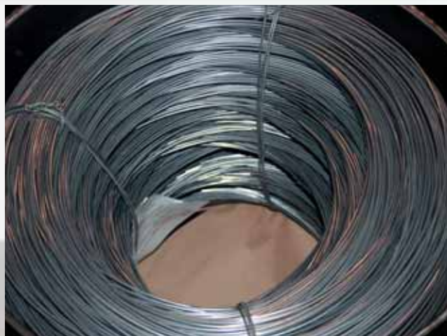
Рис. 1. Проволока ПП-Нп-19 ГСТ с улучшенной рецептурой
