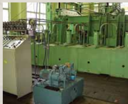
Рис. 7. Электрогидравлические приводы стенда для ресурсных испытаний рам вагонных тележек.
