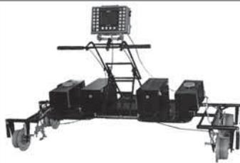
**УДС2-РДМ-22** – новейший ультразвуковой дефектоскоп предназначен для обнаружения и регистрации дефектов в обеих нитях железнодорожного пути по всей длине и сечению рельса.
