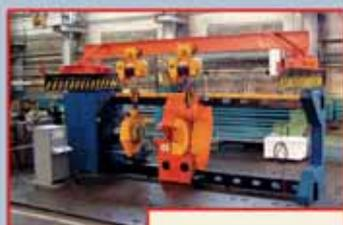
Прессы гидравлические насадочные, для запрессовки-выпрессовки колесных пар, деталей электромашин. Модели: 3930 (ус. 1000 кН), 3932 (ус. 1600 кН), 3934 (ус. 2500 кН), 3936 (ус. 4000 кН), 3938, 3938-01, 3938-01А (ус. 6300 кН)
