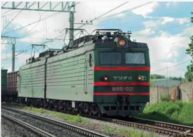
**Электровоз постоянного тока ВЛ15 способный водить поезда массой до 5–7 тыс. т. на больших уклонах**
