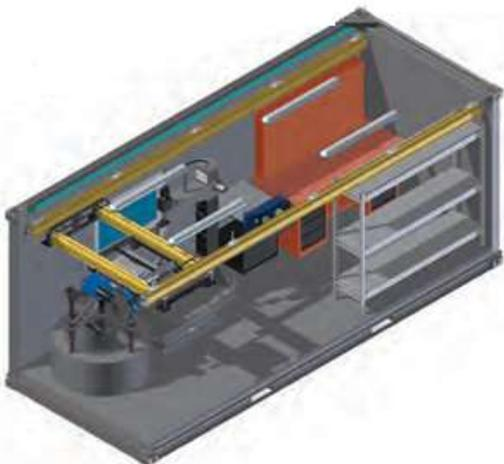
Предназначена для эксплуатации, обслуживания и ремонта дизельных двигателей спецтехники. Возможности и комплектация мастерской зависят от марки техники, специфики выполняемых работ. Комплектация возможна для проведения технического обслуживания, текущего ремонта, среднего ремонта, капитального ремонта.
