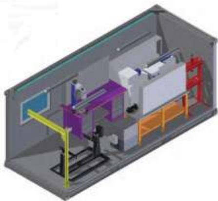
Предназначена для эксплуатации, обслуживания и ремонта автомобильной техники, специальных колесных шасси. Выпускается в различных модификациях в зависимости от вида обслуживаемой техники (автомобильной, гусеничной техники и специальных колесных шасси).
