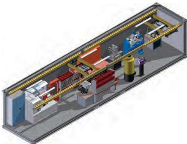
Предназначена для проведения ремонта и обслуживания горно-шахтного, карьерного, горно-обогатительного оборудования и позволяет производить ремонт в полевых условиях:
