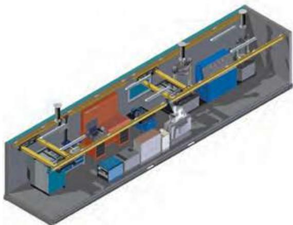
Предназначена для эксплуатации, обслуживания и ремонта машин на гусеничном ходу отечественных и иностранных марок. Возможности и комплектация мастерской зависят от марки техники, специфики выполняемых работ. Комплектация возможна для проведения технического обслуживания, текущего ремонта, среднего ремонта, капитального ремонта.
