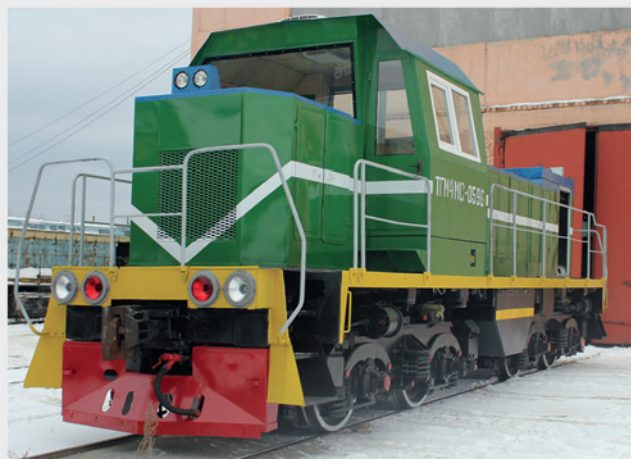
Модернизированный тепловоз ТГМ-4
